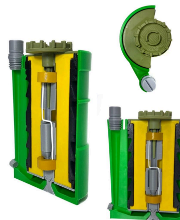
Макет протипіхотної осколкової міни кругового ураження вистрибуючої натяжної дії ПОБ «Пилка» в розрізі
